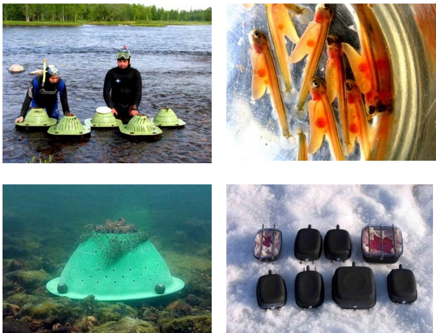
Рис. 9. Испытания разных вариантов конструкции искусственного гнезда-инкубатора в реках Умба и Лососинка
